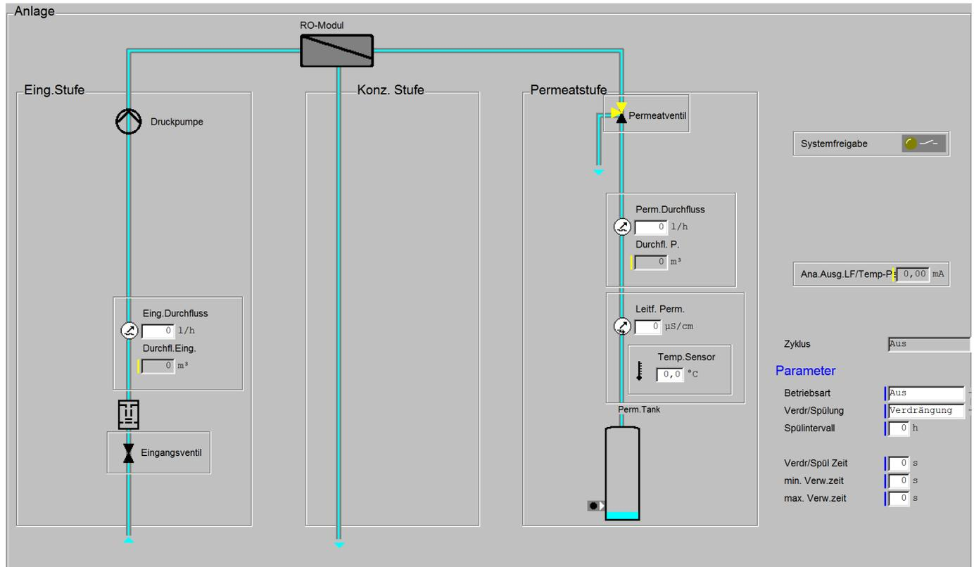
Das Steuergerät ist eine Umkehrosmosesteuerung modernster Generation zur Messung und Regelung der ..... Leitfähigkeit des Permeat ..... .
